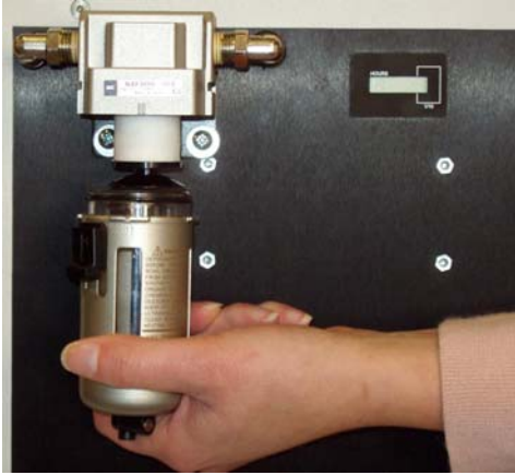
Figura 14c: Tirar de la cápsula del filtro
