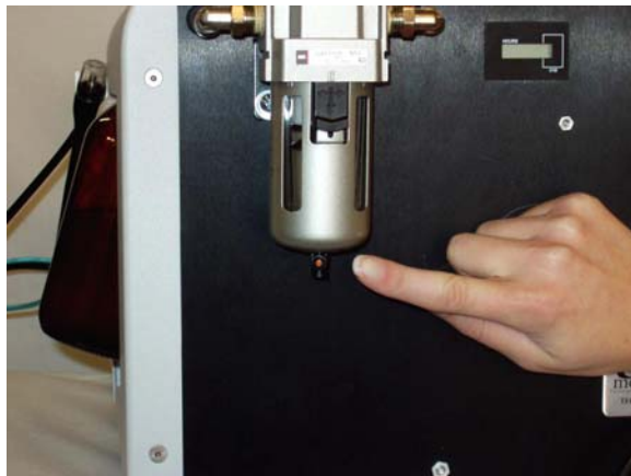
Figura 13: Drenaje del filtro de aire externo
