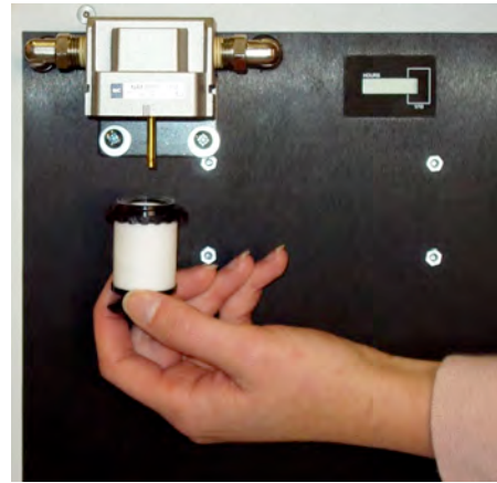
Figure 14d : Dévissez le filtre
