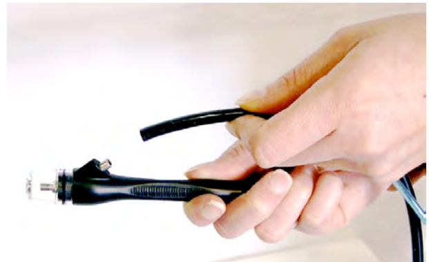
Figure 8 : Raccordez le tube de vide à la pièce à main
