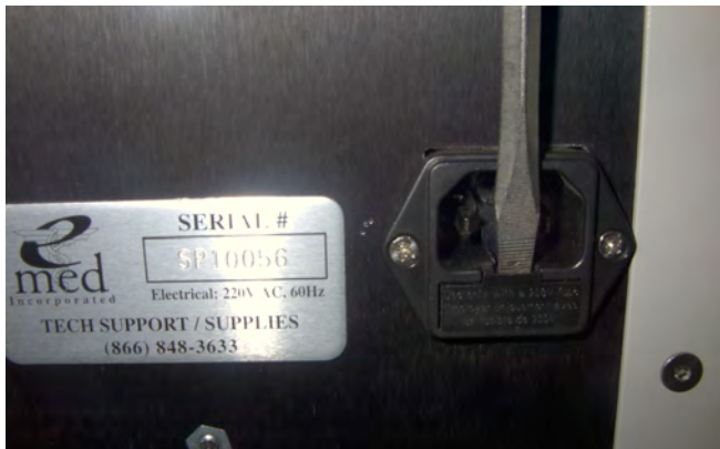
Figure 15a : Faites glisser le boîtier noir du fusible
