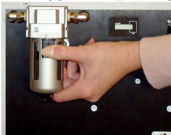
Figure 14a : Libération du filtre à air extérieur
