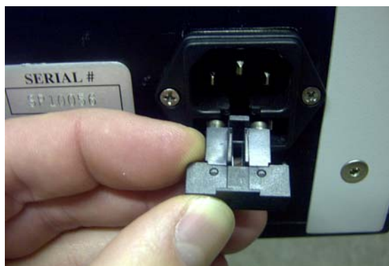
Figur 15b: Fjern sikringsboks
