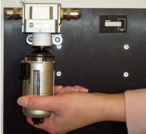
Figur 14c: Træk filterholderen ned
